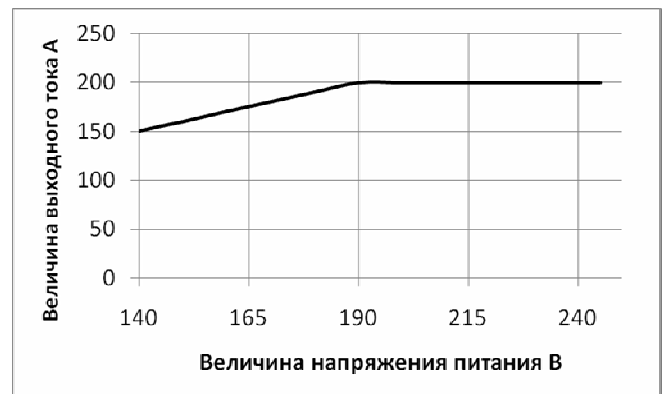
Рис. 4. Зависимость максимального выходного тока от питающего напряжения
