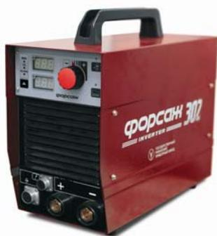
Данная статья посвящена аппарату из нового модельного ряда - «Форсаж-302» (рисунок 1), предназначенного для полуавтоматической сварки в среде защитных газов сплошной или порошковой электродной проволокой диаметром от 0,8 до 1,2 мм совместно с механизмами подачи проволоки «Форсаж-МП», «Форсаж-МПм», «Форсаж-МП5» или аналогичными механизмами с напряжением питания 24 В постоянного тока (режим MIG/MAG).
