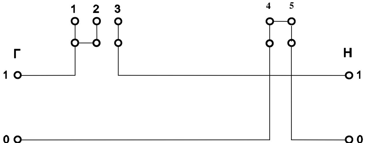
**2. Маркировка телеметрических и поверочных выходов, выходов частоты часов реального времени.**
