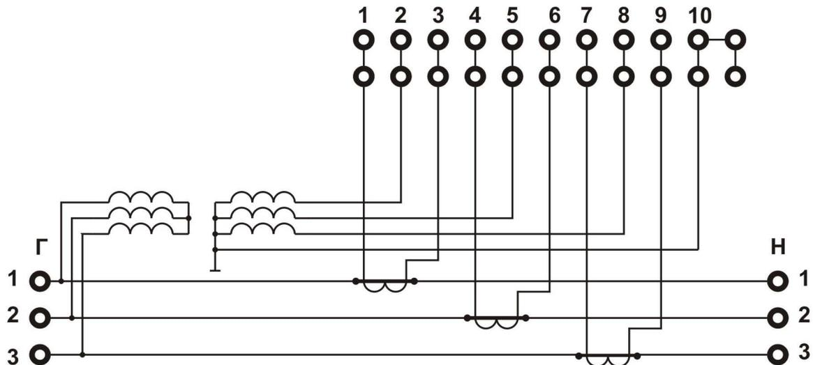
**1.2. Схема включения счетчиков с номинальным напряжением 100/58В с тремя трансформаторами напряжения и двумя трансформаторами тока.**
