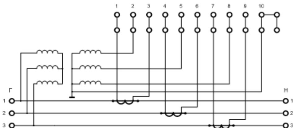
2.2 С тремя измерительными трансформаторами напряжения и двумя трансформаторами тока
