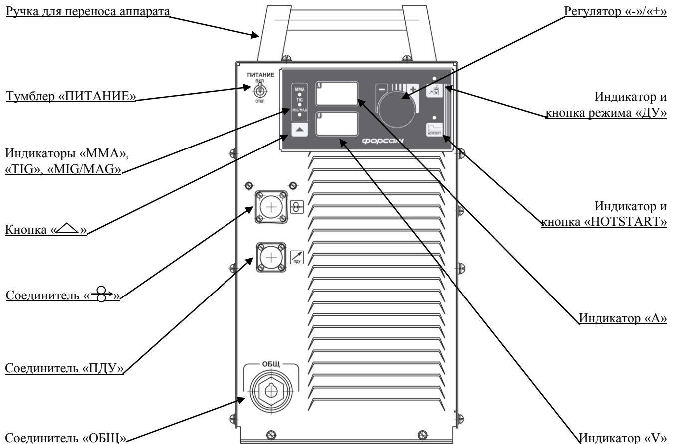
Рисунок 3.2 – Форсаж-502 ВИАМ.683151.025 (с панелью управления ВИАМ.468324.007-01)
